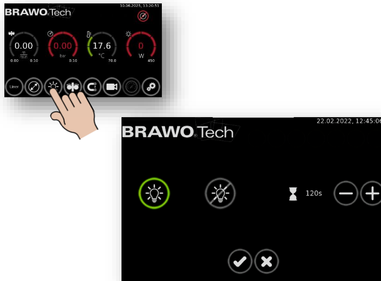
Figure 46 Menu « Activer/désactiver les LED UV »
