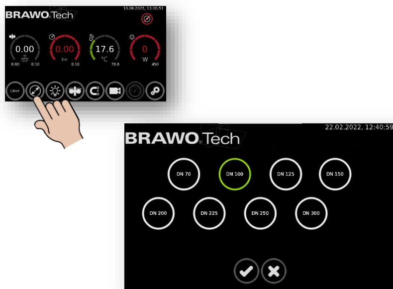
Figure 45 Menu « Présélection de dimension de conduite »
