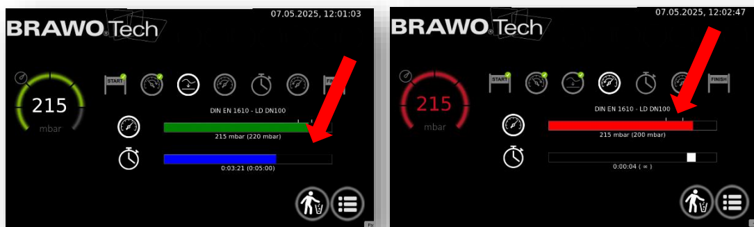
Figure 56 TiCo - Procédure de test partie 3: temps de stabilisation
