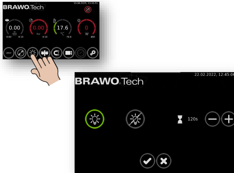
Bild 46 Menü „UV-LEDs ein-/ausschalten“
