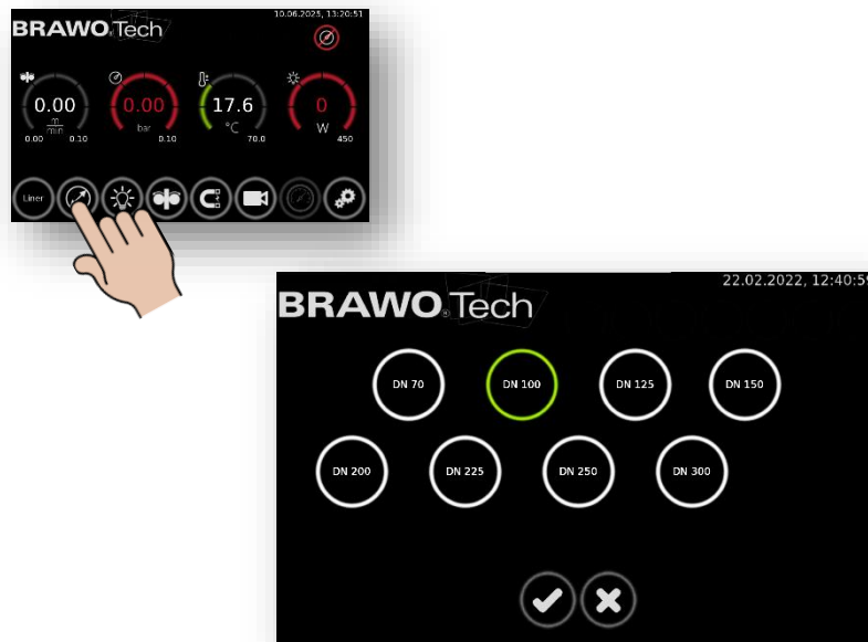
Bild 45 Menü „Vorwahl Rohrdimension“
