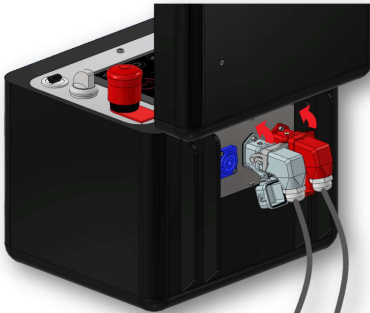
Figure 28 Rabattre l'étrier de verrouillage vers le haut
