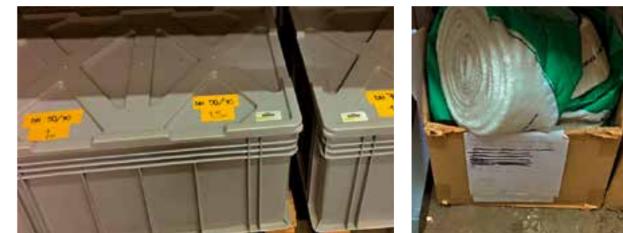
Bild 9: Vorab abgelängte Schlauchliner für die Baumaßnahme
