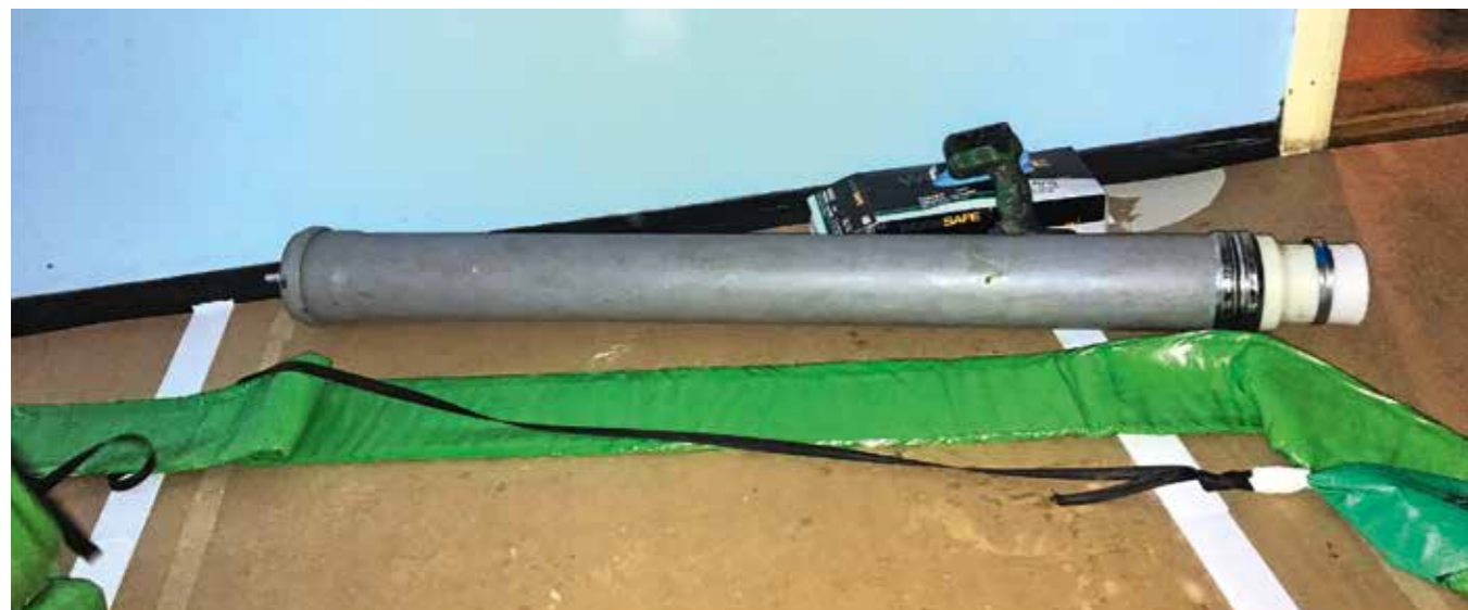
Bild 11: Liner-Inversion im Nennweitenbereich DN 50 bis DN 70 mit einer „Linerkanone“
