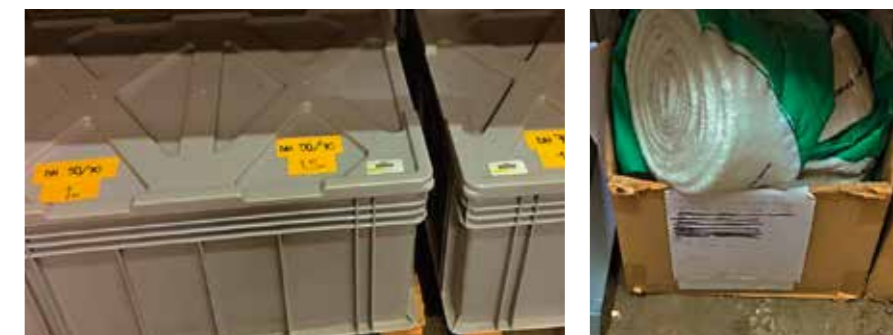
Photo 9 : Garniture d'étanchéité des tuyaux coupée à l'avance à la longueur voulue pour le projet de construction
