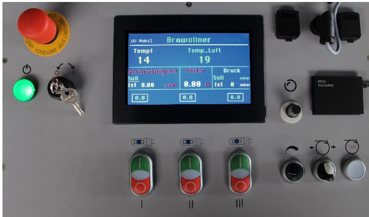
Exemple d'un module de commande d'une installation de lampe à décharge (BRAWO® LumCure)
