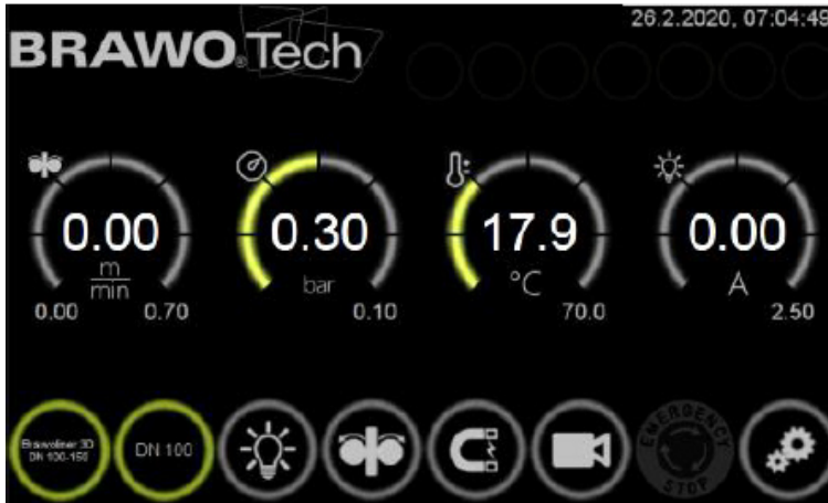
Exemple d'un module de commande d'installation à LED (BRAWO® Magnavity)
